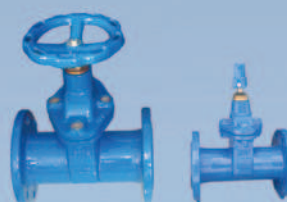
ROBINET VANNE A PD A OPERCULE ELASTOMERE SERIE LONG F5 PN 10/16/25 EN FONTE DUCTILE GGG 40 GAMME DN 40 à 500
