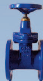
ROBINET VANNE A PD A OPERCULE ELASTOMERE SERIE COURT F4 PN 10/16/25 EN FONTE DUCTILE GGG 40 GAMME DN 40 à 500
