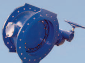
VANNE PAPILLON A BRIDE SERIE 14 PN 10/16 EN FONTE DUCTILE GGG 40 GAMME DN 150 à 2000
